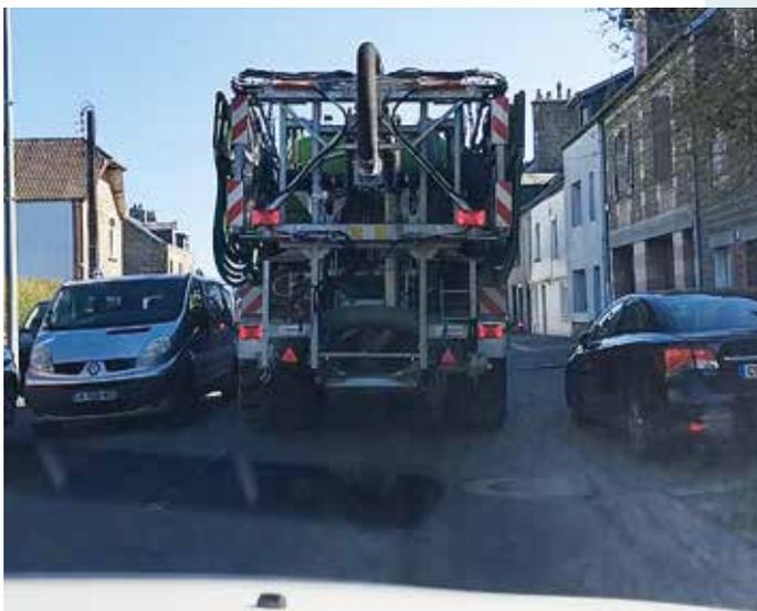
La tonne est équipée d'un gyroscope, qui permet à l'essieu suiveur de se réaligner automatiquement en fonction des contraintes. Elle se distingue également par sa grande simplicité d'attelage.
