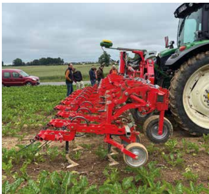
Démonstration d'une bineuse autoguidée par GPS sur l'outil
