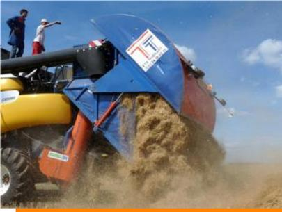
La **récupération des menues pailles** après la récolte, composées de l'enveloppe du grain et de graines d'adventices, permet d'éviter de remettre des graines d'adventices sur le sol et de limiter cette pression dans le temps. Ce procédé se réalise grâce à un récupérateur de menues pailles, utilisé dans les grandes cultures. Cette matière peut ensuite être valorisée dans un méthaniseur par exemple.
