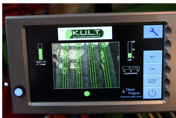
Console de guidage de la bineuse par caméra
